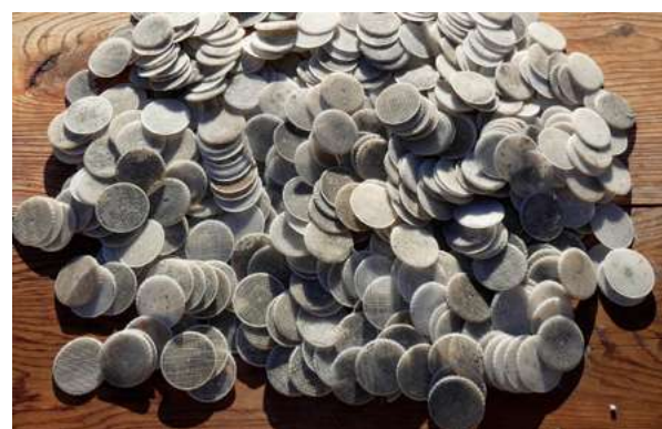
Figure 29 | Ci-dessus | Biomédias de type Biochip collectés sur les rives du lac de Serre-Ponçon après l'incident de la STEP de Molines-en-Queyras. © JP. Coulomb.
